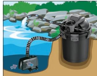
Le filtre TopClear peut être installé partout, même sous le niveau de l'eau.
