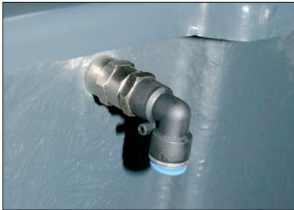
Connexion rapide du tuyau à air sans collier. Facile et sûr: en haut et par l'extérieur, pas besoin de clapet anti-retour.
