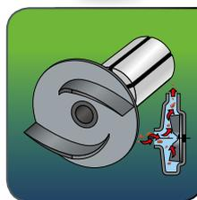
Das Vortex Schaufelrad kann mühelos Schmutzpartikel transportieren.
