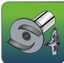
Das Vortex Schaufelrad kann Schmutzpartikel bis zu einer Größe von 6 mm transportieren.
