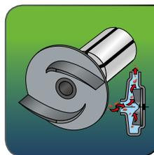
Das Vortex Schaufelrad kann mühelos Schmutzpartikel transportieren.
